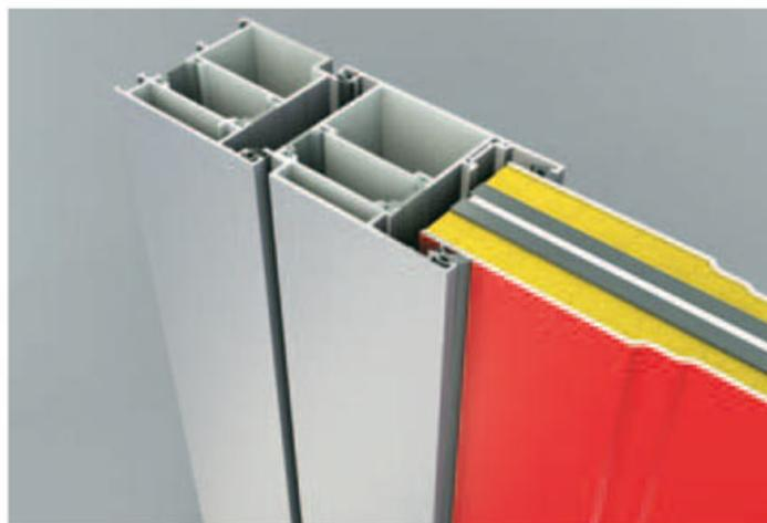
Profili ad alto isolamento termico in abbinamento ai pannelli proposti da METRA garantiscono elevate prestazioni di isolamento con valori  $U_d = 1.5 \text{ W/m}^2\text{K}$  secondo EN 10077-1.
