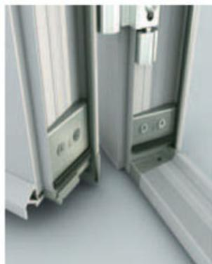
I tappi inferiori, alloggiati sul telaio fisso e sull'anta, sono stati progettati per garantire una perfetta continuità nella tenuta perimetrale con un'assenza totale di spifferi anche nelle parti inferiori più critiche. Le caratteristiche di progettazione dei tappi permettono di ottimizzare i tempi di lavorazione e di montaggio.
